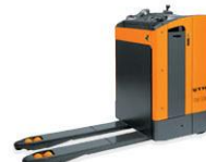
SU Эл. тележка с сидением водителя Г/п 2,0 т. В.п. 120 мм Ast 2220 мм
