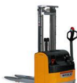
EGV Штабелер Г/п 1,4-1,6-2,0 т. В.п. до 5466 мм Ast 2210-2550 мм Ост. г.п. - 600 кг.
