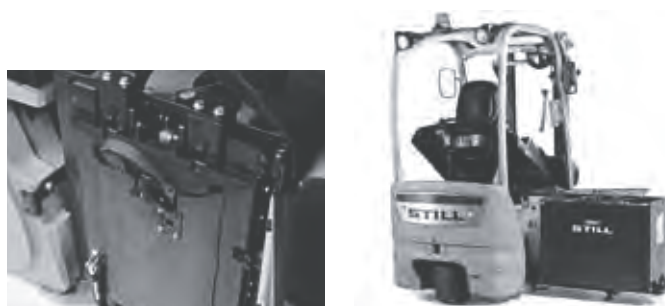
4) Бортовая платформа с АКБ для замены с электротележкой
