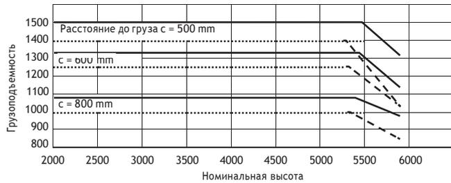
Грузоподъемности RX 20-15 тройного подъемника
