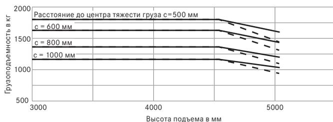
Базовая грузоподъемность RC 40-18 с трехсекционной мачтой, шинами SE
